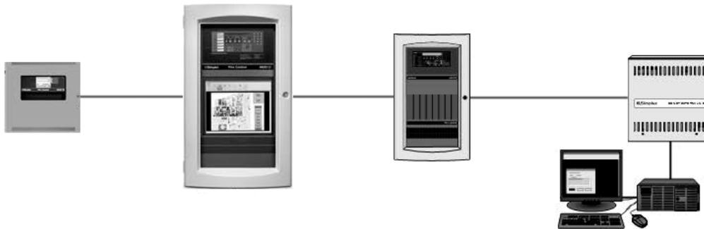
Figura 6: Topologia de rede linear de execução única (sem conexão em T)
